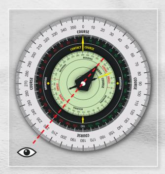
Una volta dedotto l'AoB approssimativo, potrete cercare di determinare la rotta del contatto. Per prima cosa, impostate la rotta dell'U-Boot e il rilevamento del bersaglio, quindi immaginate che la freccia rappresentante il rilevamento si estenda da una parte all'altra del Regolo d'Attacco. Ora guardate il disco nero traguardando il bordo esterno dell'intero disco, dalla parte opposta al verso della freccia.
